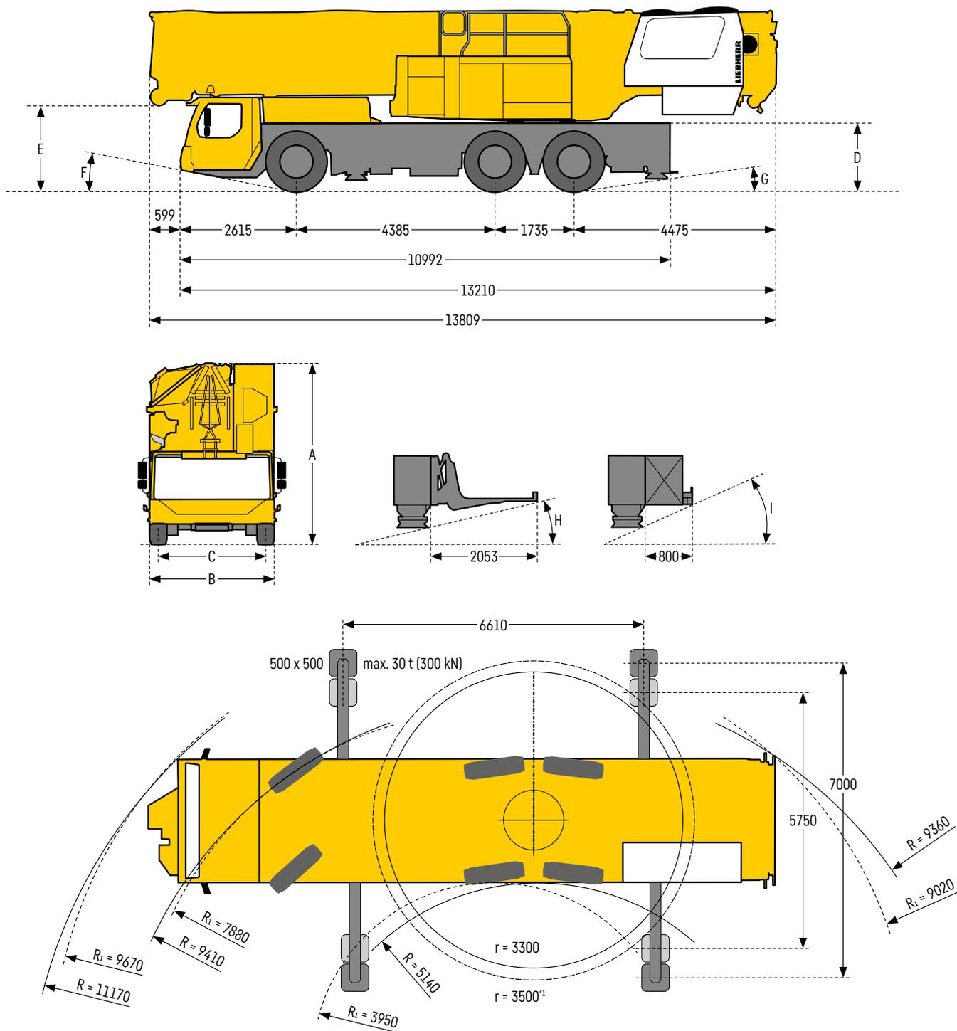
R<sub>1</sub> = Allradlenkung · All-wheel steering · Direction toutes roues · Dirección en todos los ejes · Besturing van alle wielen · Рулевое управление всеми поворотными колесами
